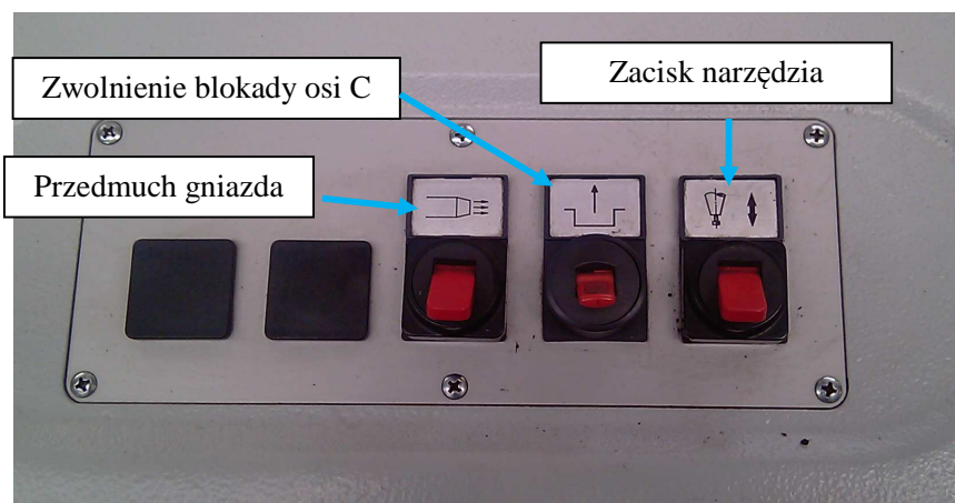
Rys. 6. Pulpit urządzenia pomiarowego narzędzi
