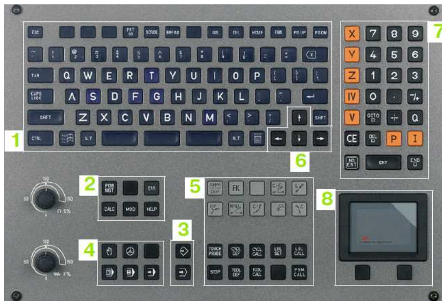
Rys. 2. Przykładowa klawiatura układu sterującego iTNC530
